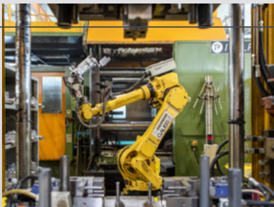
Robô para extração das peças da injetora.
